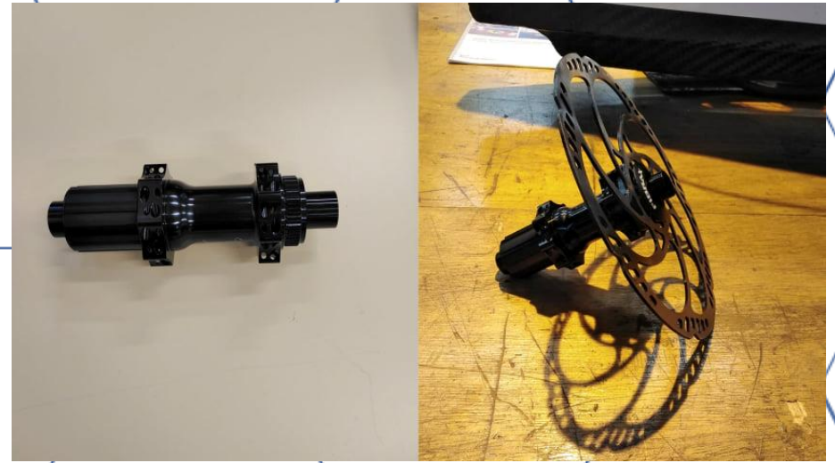
Photos des roues libres avec le disque de freinage (à droite) et sans (à gauche)
